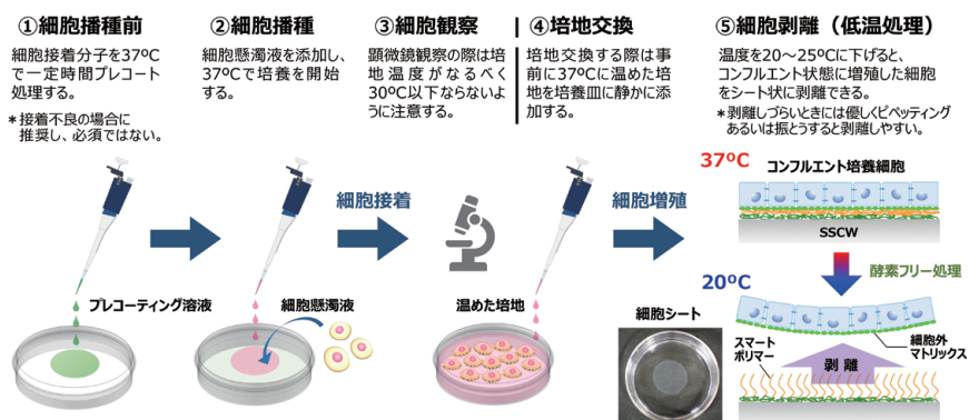
図3. SSCW ® を利用した細胞シート作製操作の流れ
